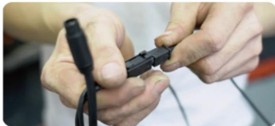
▲ Le câble de l'objectif doit éviter de se plier à angle vif, sinon il endommagera la couche de protection, provoquera une transmission anormale du signal ou interférera avec d'autres équipements électroniques.
