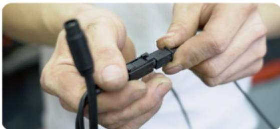
Należy unikać zginania kabla kamery F1 pod ostrym kątem, ponieważ zginanie go pod ostrym kątem może uszkodzić jego ekranowanie i spowodować niewłaściwą transmisję sygnału lub zakłócenia innych urządzeń elektronicznych urządzenia.
