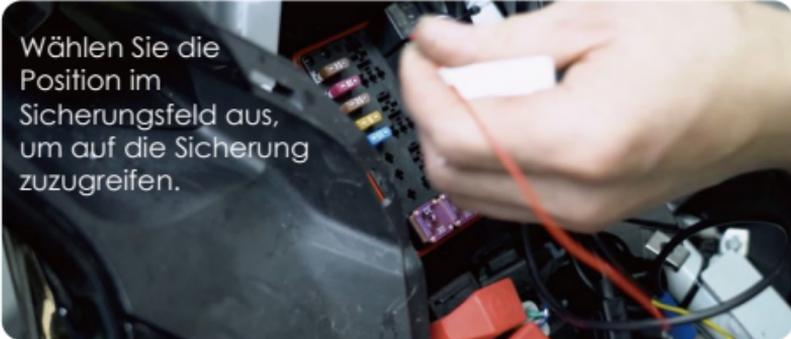
Wählen Sie die Position im Sicherungsfeld aus, um auf die Sicherung zuzugreifen.
