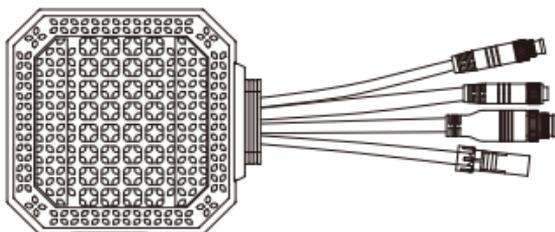
3) Afin d'améliorer l'efficacité de dissipation thermique de l'unité principale F1, le boîtier de protection peut être retiré et réinstallé.
