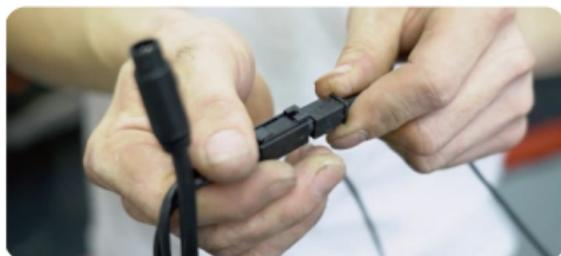
▲ F1-Kameralinie vermeidet scharfe Winkelbiegungen, da eine spitze Winkelbiegung die Abschirmschicht beschädigt, eine abnormale Signalübertragung verursacht oder andere elektronische Geräte stört.
