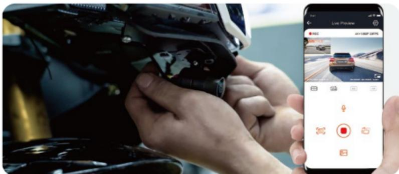
Une fois l'objectif installé, vous pouvez accéder à l'application VANTRUE CAM pour un aperçu en temps réel, puis cliquer sur la ligne d'étalonnage [田] en bas à gauche de l'écran pour confirmer la direction de l'objectif.
